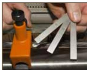
Phase 1 : Pour ajuster le dépassement des fers de l'arbre. Plusieurs hauteurs 0.8-1-1.2 mm - réglage sur l'arbre hors fers.
