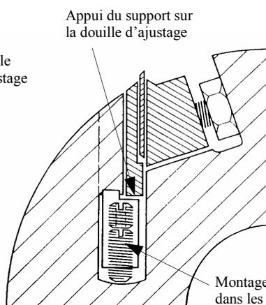
Montage des douilles dans les logements prévus à cet effet (logement des ressorts)
