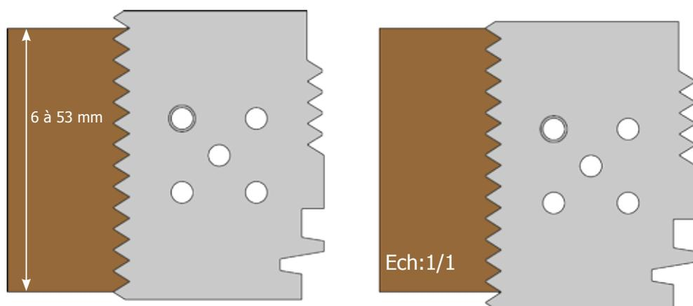
En deux passes : Pour la seconde passe, monter la lame avec une bague épaisseur 2mm O90.0450.020 (bague non livrée)
