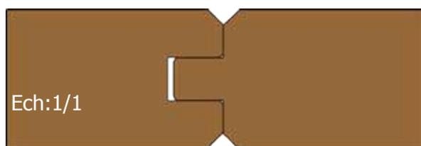
Assemblage avec Chanfreins 14 à 34 mm
