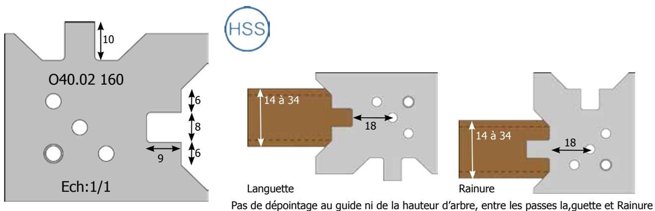
Pas de dépointage au guide ni de la hauteur d'arbre, entre les passes la,guette et Rainure
