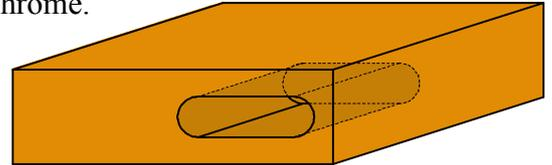
**Application :** Conçue pour réaliser des mortaises à bords arrondis et fond plat.
