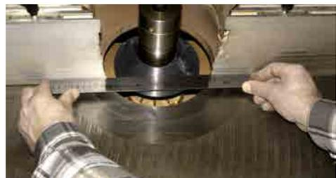
fig B Réglage guide - empreinte haute
