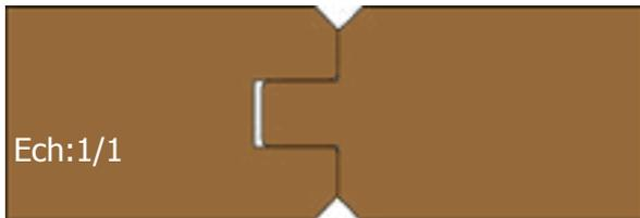
Assemblage avec Chanfreins 24 à 34 mm
